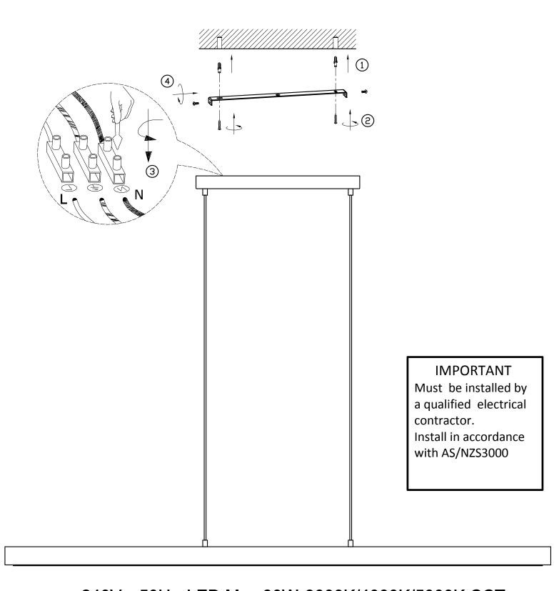
240V ~ 50Hz LED Max.30W 3000K/4000K/5000K CCT TRAILING EDGE DIMMER
